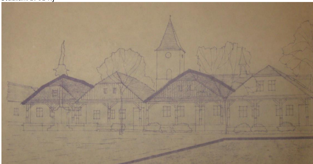
Rysunek 2. Wnętrze urbanistyczne - szkic przedstawiający uwzględnienie propozycji w zakresie: likwidacja drogi poprzecznej, przywrócenie dachów przyczółkowo – naczółkowych oraz wymiana detalu (słupy, okna) [Studium urbanistyczno-konserwatorskie Lipnicy Murowanej W. Niewalda 1981 r.]
